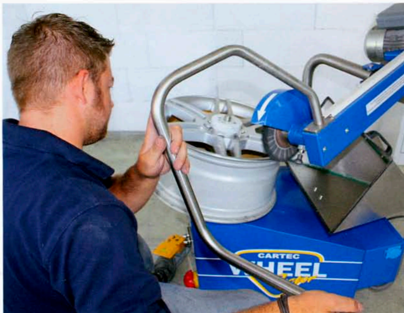
Schnell erledigt: Der Ausschleifvorgang auf der Cartec-Maschine dauert meist nur wenige Minuten. Bilder: Cartec
