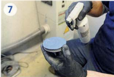
7 Jetzt kommt ein befeuchtetes Schleifpad mit feiner Körnung zum Einsatz
