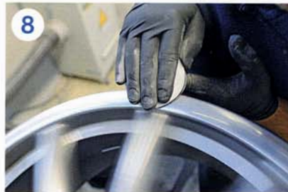
8 Mit dem Schleifpad wird die serienmäßig vorhandene Schliff-Struktur wieder hergestellt
