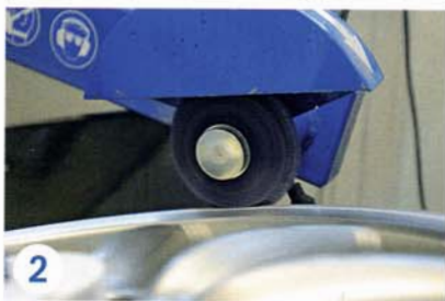
2 Mit einer größeren Schrupscheibe wird der Felgenreif zunächst eben geschliffen
