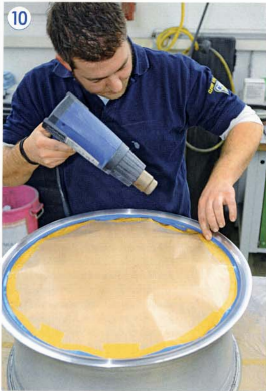
10 Die exakte Lackierkante wird mit dem blauen Klebeband festgelegt. Mit etwas Wärmezufuhr schmiegt es sich perfekt an
