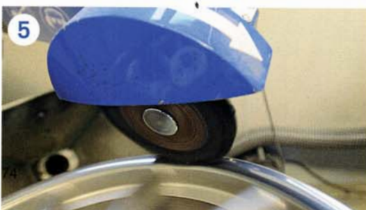
5 Nach mehreren Umläufen mit der rotierenden Schwabbel-scheibe wird Hochglanz erzielt
