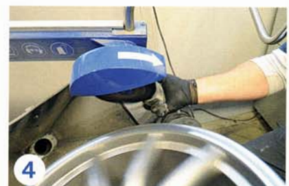
4 Jetzt kommen Schwabbel-scheibe und Polierwachs für eine perfekte Oberfläche zum Einsatz
