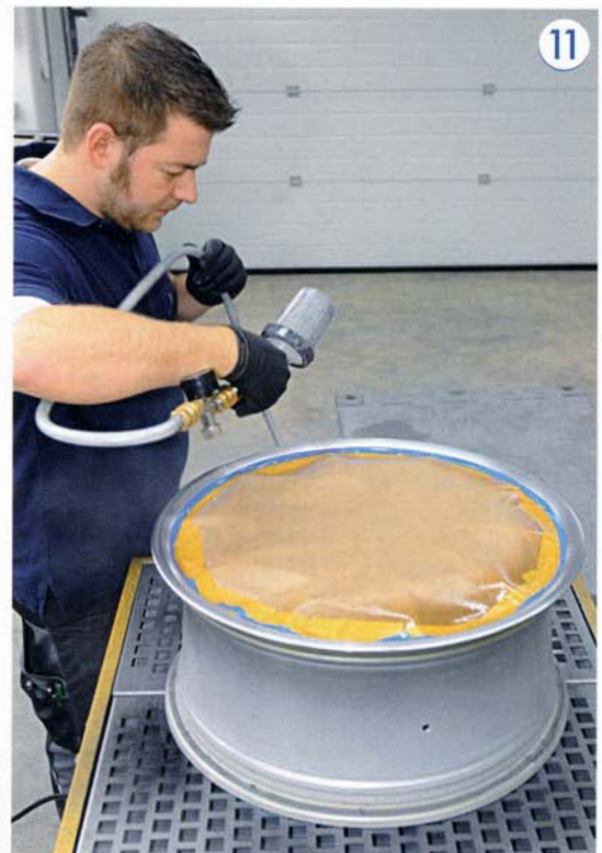
11 Mit einem speziellen Klarlack wird die Oberfläche nun versiegelt
