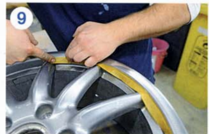
9 Der bearbeitete Felgenreif wird für die nun folgende Lackierung zunächst grob abgeklebt
