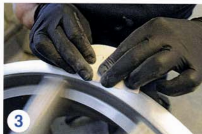
3 Händisch und mit feinerem Schleifpapier erfolgt nun die Feinbearbeitung der Fläche
